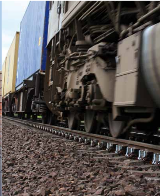
▲ Verschiedene Maßnahmen werden bereits umgesetzt, um die Lärmbelastung an den Schienenwegen zu reduzieren. Schallschutzwände sind die sichtbarsten Ergebnisse. Getestet wird derzeit auch der Einsatz von Schienenstegdämpfern, die die Schwingungen der Schienen
