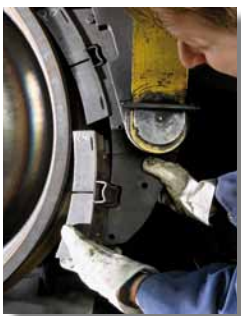
▲ Die K-Sohle reduziert das Rollgeräusch von Güterwagen um fast zehn dB(A). Foto: DB AG/ Heiner Müller-Elsner
